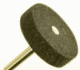
Tupe vrtáky je možné ostřít brusnými kameny na tvrdokovy nebo pomocí kotoučku od stejného výrobce. Díky složení (karbid-křemíku SiC a prům. diamantu) a kvalitnímu provedení zaručuje perfektní a rychlé naostření. Tento kotouček je vhodný do všech typů vrtaček. Při ostření vrtáku dbejte na to, aby byly funkční plochy ostřeny pod stejným úhlem a obě plochy ostření byly stejně dlouhé. Možno použít až do 4 000 ot./min.
